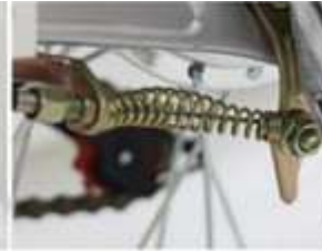
2 Remkabel behuizing 3 Voorspanningsschroef
